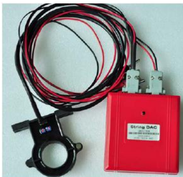
Рис 2.3.7 Модуль String DAC с последовательными кабелями
